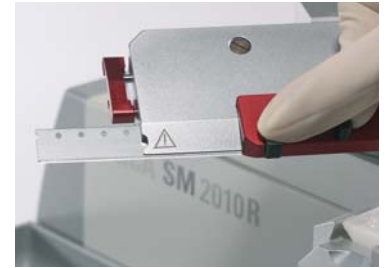
Extracción segura de las cuchillas desechables
